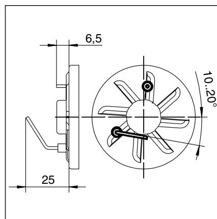
La utilización de **gas propano** necesita la colocación en el deflector del obturador GP ubicado en la pletina (ver transformación).
