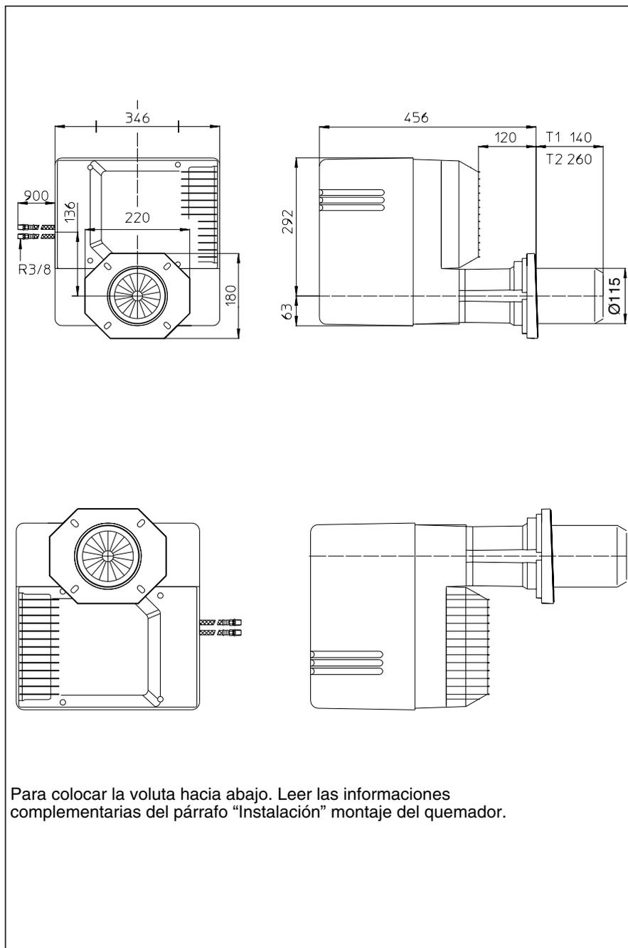
Para colocar la voluta hacia abajo. Leer las informaciones complementarias del párrafo "Instalación" montaje del quemador.
