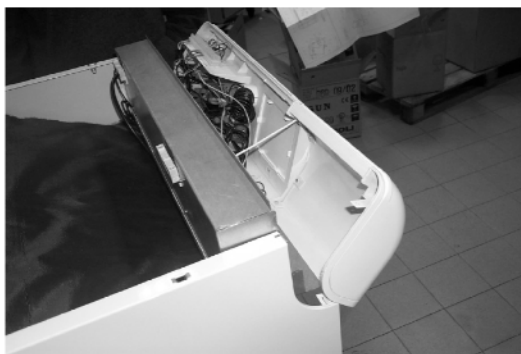
Fig. 6 - Girar hacia adelante el panel de mandos.
